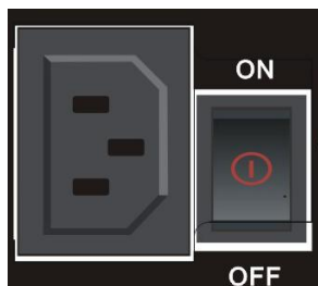
: 机箱后部电源插座和电源开关
